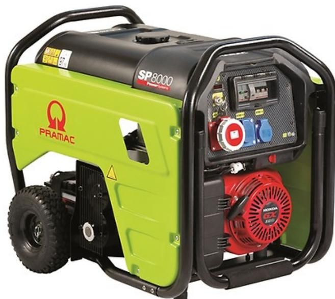
Dieser Stromerzeuger erfüllt die höchsten Ansprüche hinsichtlich Personenschutz (Isolationsüberwachung), Geräteschutz (Schutzklasse IP 54), Anlaufstromverhalten (elektronisch geregelter Synchrongenerator 4-fach I-Nenn) und Schiefasttauglichkeit (unterschiedliche Belastung der einzelnen Phasen).
