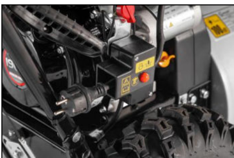
E-Start mittels 230V Stecker
