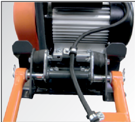
Komfortable Vibrationsdämpfer, Handgriffbefestigung und praktischer Tragegriff.
